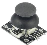
Una palanca de mando es un dispositivo de entrada para ordenadores, especialmente en el ámbito de los juegos. Con la palanca de mando integrada en el modelo de fábrica se puede realizar la calibración fina de los modelos individuales. Se pueden diferenciar dos tiempos de función: Digital, donde la dirección de la palanca se detecta a través de cuatro contactos.
