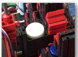
El contenedor con la materia prima es transportado en el dispositivo de ingreso y salida hacia la posición de recogida del brazo mecánico del almacén con techo alto. Aquí, el contenedor es recogido, transportado hacia el lugar de almacenamiento de la estantería elevada y allí es depositado.
