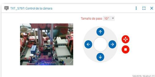
La cámara se controla mediante la palanca de mando virtual. El punto rojo indica dónde se encuentra el punto medio de la cámara. Mediante el botón «Amplitud de recorrido» podrá determinar en qué grado debe girar la cámara al hacer clic en una flecha. Mediante ambos botones rojos, se puede centrar o detener la cámara.
