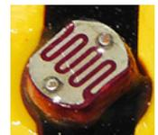
**Importante:** La fotorresistencia tiene un valor de resistencia de 0 - >1 MOhm (en oscuridad total). Mediante un software se puede leer un valor máximo de 15.000 en el controlador TXT
