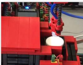
El brazo del manipulador de aspiración al vacío gira a la posición de depósito, desciende y coloca la materia prima en el contenedor que se encuentra preparado.
