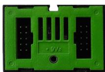
El sensor que se encuentra en una placa en la carcasa sirve para medir el gas, la presión atmosférica, la humedad y la temperatura del aire. El bloque de construcción se conecta a través de un cable plano con el TXT.
