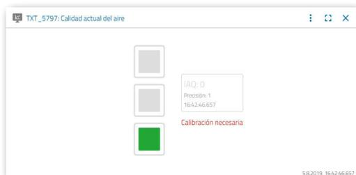
A través de la ventana «Calidad actual del aire», se muestra un valor de la calidad del aire a partir de tres cuadrados. En función de la calidad del aire medido, se encienden las indicaciones. De esta forma, estará verde para muy buena calidad del aire, verde y amarillo para buena, amarillo para satisfactoria, verde y rojo para suficiente y rojo para mala.
