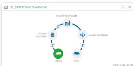
En primer lugar, coloque una pieza blanca en la entrada de material. La pieza de trabajo (materia prima) interrumpe la barrera fotoeléctrica. Este proceso es conocido como «Entrega» y se encuentra representado en la ventana del panel de control de «Proceso productivo» con el icono «Entrega» resaltado en color verde.
