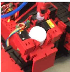
Por último, la pieza de trabajo es colocada en la bandeja de salida de la estación de ingreso y salida.
