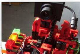
Observe a través de la pantalla de estado cuándo la instalación está lista para la calibración. Lo podrá reconocer al ver que las 3 lámparas, o bien, las 3 luces LED, roja, amarilla y verde, se iluminan al mismo tiempo en la estación de sensor. De no ser así, puede retirar la tarjeta.
