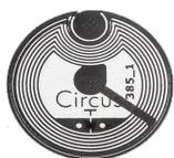
En primer lugar, se eliminan todos los datos de la memoria y se marca la pieza de trabajo como materia prima. El lector describe la etiqueta NC que se encuentra en la pieza de trabajo **NTAG213** con los datos relevantes para la pieza de trabajo.
