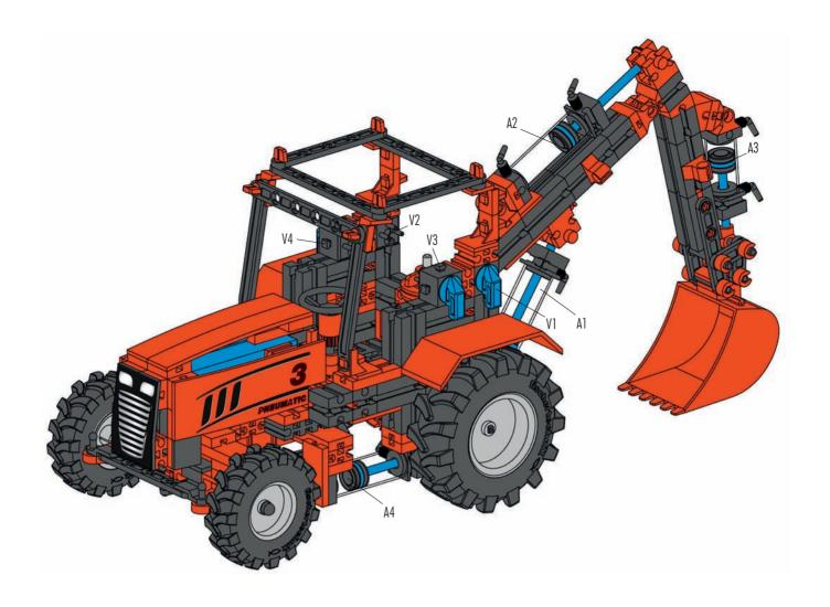
Schlauchanschlussplan Air line layout plan Plan de raccordement de conduits Aansluitschema van slang Racor de empalme Plano de conexão de mangueira
