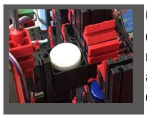
O recipiente com a matéria-prima é transportado no dispositivo de entrada/saída para a posição de recebimento do braço da garra da unidade de estante alta. Aqui, o contentor é recolhido, transportado para o armazém na estante alta e armazenado lá.
