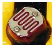
**Importante:** O fotorresistor tem um valor de resistência de 0 - >1MΩ (na escuridão completa). No software TXT Controller, é possível fazer uma leitura de um valor máximo de 15.000
