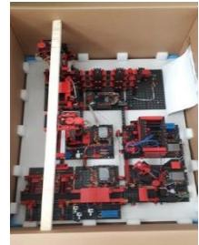
Conekte a placa adaptadora da Fábrica De Aprendizagem 4.0 no SPS. Isso pode ser feito com cabos de fita nos conectores de 34 pinos ST1 ou por meio dos terminais.
