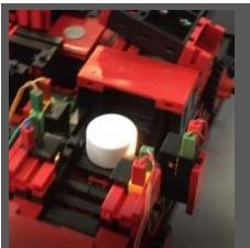
No caminho para a esteira de separação, a peça de trabalho passa por uma detecção de cores.
