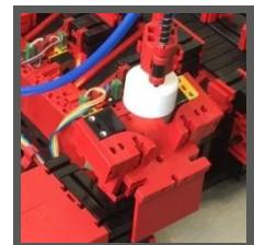
Dependendo da cor detetada, a peça de trabalho é ejetada pneumáticamente da correia transportadora à frente de uma calha de material. A peça de trabalho está localizada numa área de recebimento e pode ser transportada daqui com a ventosa a vácuo.
