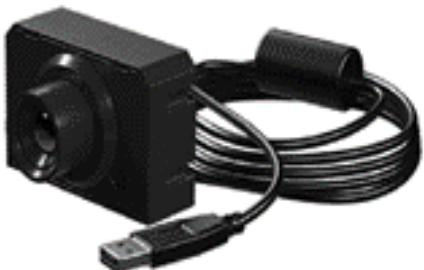
A câmera de monitoramento instalada na estação de multiprocessamento (MPO) é conectada ao controlador TXT através de uma interface USB. Ela pode ser controlada através do painel de controle na nuvem fischertechnik.
