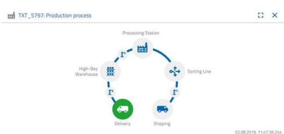
Insira uma pedra branca na entrada do material. A peça de trabalho (matéria-prima) interrompe a barreira de luz. Este processo é identificado como "Entrega" e destacado a verde na janela do painel "Processo de produção" com o ícone "Entrega".
