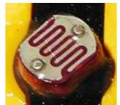
**Importante:** La fotoresistenza ha un valore di resistenza di 0 - >1M $\Omega$  (con la totale oscurità). Nel software si può leggere un valore di massimo 15.000 sul controller TXT
