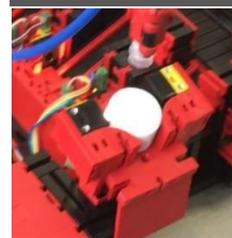
Alla fine, il pezzo in lavorazione viene depositato nello scaffale di uscita della stazione di ingresso e di uscita.
