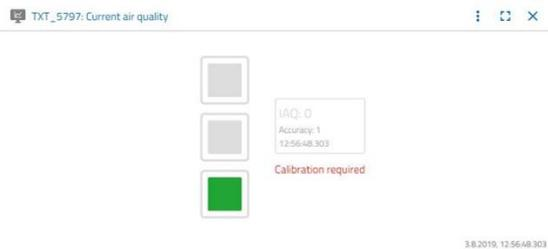
Tramite la finestra **"Attuale qualità dell'aria"** si ottiene un valore della qualità dell'aria visualizzata otticamente, con l'aiusilio di tre rettangoli. In base alla qualità dell'aria misurata vengono attivate le visualizzazioni. Quindi, verde sta per molto buono, verde e giallo per buono, giallo per soddisfacente, giallo e rosso per sufficiente e rosso per insufficiente.
