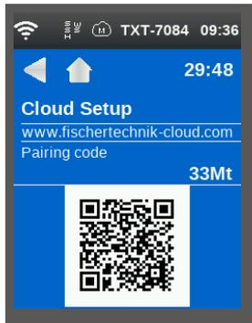
Quando il controller TXT è in grado di creare un collegamento con il cloud, appare un codice QR e un codice di accoppiamento. Ora si hanno 30 minuti di tempo per aggiungere il controller TXT al proprio account nel cloud. Dopo questo lasso di tempo il processo di accoppiamento deve essere riavviato.
