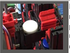
Il contenitore con la merce grezza viene trasportato nel dispositivo di ingresso e di uscita alla posizione di prelievo del braccio prensile del magazzino verticale. Qui il contenitore viene prelevato, trasportato al punto di stoccaggio nello scaffale alto e ivi depositato.
