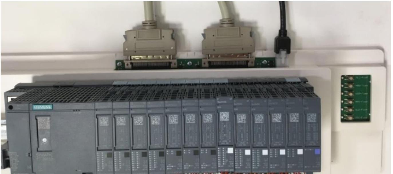
L'alimentatore a 24 V è collegato tramite il connettore a 6 poli sulla scheda del PLC. Inserire ora l'alimentatore da 24 V nella presa.
