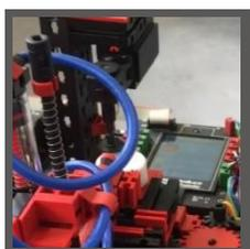
La slitta di trasporto con la ventosa a vuoto appoggia il pezzo sul tavolo rotante, con il quale questo pezzo viene ruotato verso la fresa. Dopo che il processo di fresatura è stato eseguito, il pezzo in lavorazione viene ulteriormente ruotato di 90 gradi e spinto in modo pneumatico su un nastro trasportatore.
