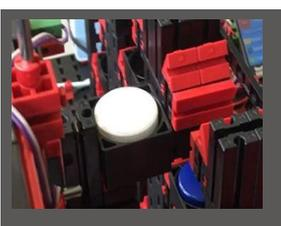
O recipiente com a matéria-prima é transportado no dispositivo de entrada/saída para a posição de recebimento do braço da garra da unidade de estante alta. Aqui, o contentor é recolhido, transportado para o armazém na estante alta e armazenado lá.
