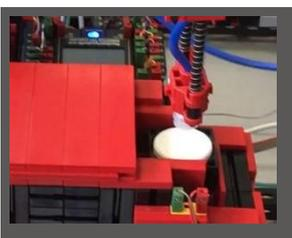
O braço de aspiração a vácuo gira até a posição de armazenamento, desce e coloca a matéria-prima no recipiente preparado.
