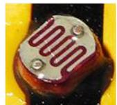
**Importante:** O fotorresistor tem um valor de resistência de 0 - >1MΩ (na escuridão completa). No software TXT Controller, é possível fazer uma leitura de um valor máximo de 15.000
