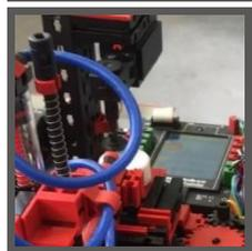
O deslizamento de transporte com ventosa a vácuo coloca a peça da mesa giratória até a fresagem. Após o processo de fresagem, a peça de trabalho é girada em 90 graus e empurrada pneumaticamente sobre uma correia transportadora.
