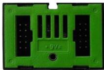
O sensor, localizado numa placa de circuito na carcaça, é usado para medir gás, pressão do ar, humidade e temperatura do ar. O módulo está
