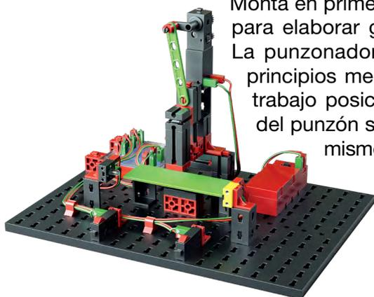
Monta en primer lugar el modelo de la punzonadora. Sirve para elaborar grandes cantidades de una misma pieza. La punzonadora de accionamiento manual se basa en principios mecánicos simples. Tú colocas una pieza de trabajo posicionada entre la barrera de luz. La carrera del punzón se realiza accionando los dos pulsadores al mismo tiempo. La fuerza de punzonado se genera, en el caso de tu máquina, mediante el motor con engranaje. Los componentes más importantes de la punzonadora son:
