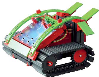
■ Una vez que hayas probado cómo marcha el vehículo de orugas hacia delante y atrás, y cómo realiza los cambios de dirección, te espera otro desafío. El vehículo debe detectar obstáculos con ayuda de dos pulsadores en el frente y sortearlos automáticamente.
