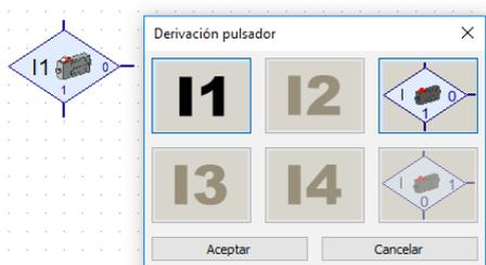
Para la consulta del pulsador empleas la orden "Derivación pulsador". Aquí tienes 3 conexiones. El programa determina: Si el pulsador no se ha oprimido, ir a la salida 0; si el pulsador se ha accionado, ir a la salida 1.
