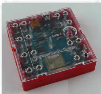
■ El BT Smart Controller es el núcleo de este kit de construcción ROBOTICS. Para ti no visibles, el módulo Controller posee un sinnúmero de elementos electrónicos. La interacción de estos elementos con tu ordenador y un programa de control, te posibilita controlar los modelos en el ROBOTICS BT Smart Beginner Set.
