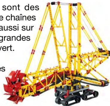
La direction se fait à l'aide de chaînes de transmission fonctionnant à des vitesses différentes. Pour aller vers la gauche, la chaîne de droite tourne plus vite que la chaîne de gauche. Pour s'arrêter, la chaîne arrête de tourner.
