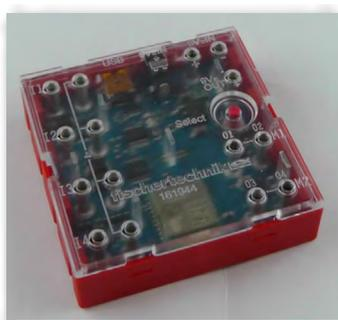
■ Le BT Smart Controller est la pièce maîtresse de cette boîte de construction ROBOTICS. L'élément de construction du Controller est composé d'innombrables composants électroniques, qui sont invisibles pour vous. L'interaction de ces composants avec l'ordinateur et un programme de commande permettent de commander les maquettes de la boîte ROBOTICS BT Smart Beginner Set.
