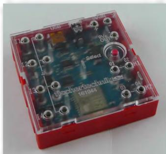
■ O BT Smart Controller é o coração deste módulo ROBOTICS. O elemento do Controller possui uma série de componentes eletrônicos que não são visíveis para você. O trabalho conjunto desses componentes com um computador e um programa de controle permite que você controle os modelos no ROBOTICS BT Smart Beginner Set.
