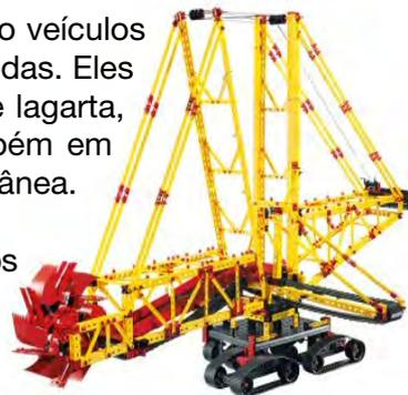
A direção ocorre através de diferentes correntes de acionamento de alta velocidade. Se você quiser virar para a esquerda, por exemplo, a corrente direita gira mais rápido que a esquerda. Se você quiser girar em determinado ponto, a corrente fica parada.
