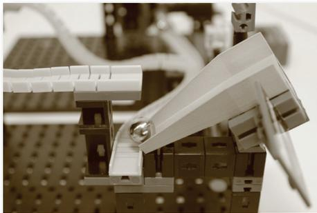
En esta chicana la tolva de recogida está montada sobre un cubo articulado. En el momento que una bola rueda del carril flexible sobre la trampilla, el componente se vuelca hacia abajo por el peso de la bola. La bola puede entonces continuar rodando la pista de recorrido hacia abajo por el siguiente carril flexible ubicado abajo.
