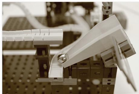
Le cône collecteur de cette chicane est monté sur un cube articulé. Dès qu'une bille roule du rail souple sur la trappe, le poids de la bille a pour effet de faire basculer l'élément de construction. Ensuite, la bille peut poursuivre sa trajectoire à travers le parcours vers le bas sur le rail souple inférieur.
