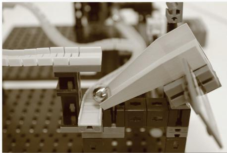
O funil de captação está montado nessa chicana sobre um cubo articulado. Logo que uma esfera rola do trilho flexível sobre o alçapão, o componente inclina devido ao peso da esfera para baixo. A esfera pode, então, continuar a rolar para baixo para o próximo trilho flexível inferior e pelo circuito.
