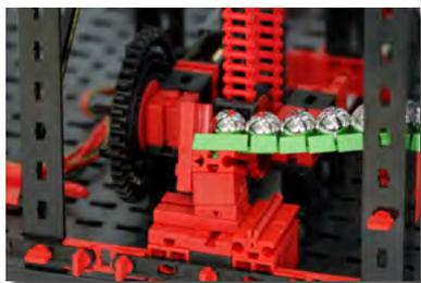
Todas las pistas de recorrido mostradas en las instrucciones de construcción contienen un elevador. Este está constituido de una cadena accionada a la que están fijados soportes magnéticos de bolas.
