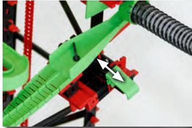
Mediante el desvío de posición con palanca de mando es posible determinar el guiado de la pista.
