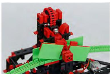
En el momento que un soporte de bolas pasa junto a una bola de metal en el depósito del modelo, esta es atraída por el imán y transportada hacia arriba. Una vez que llega arriba la bola se quita y rueda a través de la pista de recorrido.
