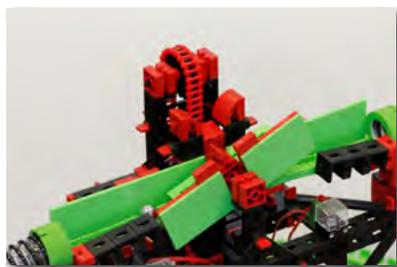
La bille est raclée par le support à billes magnétique avant de rouler dans l'aiguillage automatique qui dirige toutes les billes par alternance à droite et à gauche.
