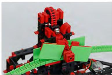
Tout les parcours contenus dans les instructions de montage comprennent un monte-charge. Ce monte-charge est composé d'une chaîne entraînée à laquelle des supports à billes magnétiques sont fixés.
