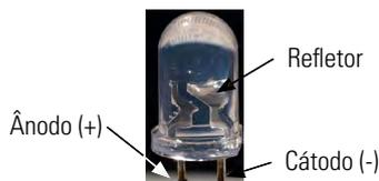
**Importante:** Os LEDs empregados no módulo são instalados num suporte de lâmpada. Aqui, você somente deve prestar atenção, como fornecido no manual de montagem, à polaridade correta.
