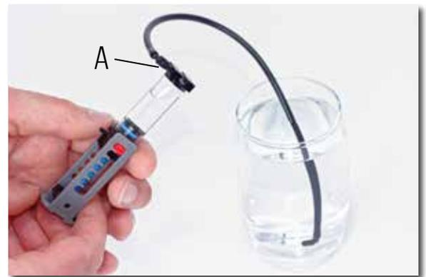
6. Bevor du nun das offene Schlauchende aus dem Wasser nimmst und es an deinen Arbeitszylinder anschließt, musst du den Arbeitszylinder ganz einfahren.
