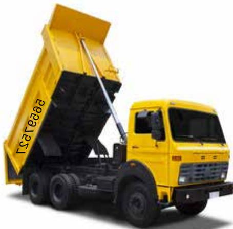
Teleskopzylinder an einem Baustellenkipper
