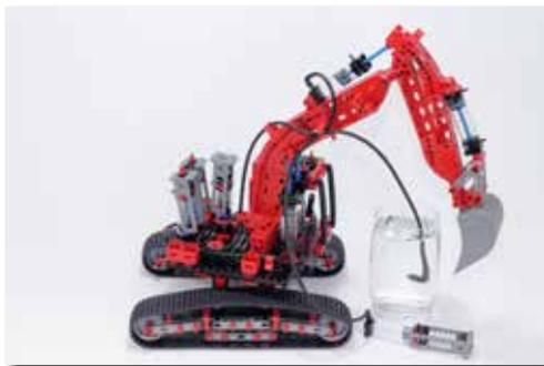
Jetzt kommst du ganz einfach an alle Steuerzylinder heran, um die einzelnen Systeme mit Wasser zu befüllen.
