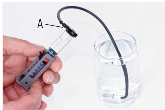
6. Avant de retirer l'extrémité ouverte du tuyau de l'eau et de le raccorder à votre cylindre de travail, vous devez rétracter complètement le cylindre de travail
