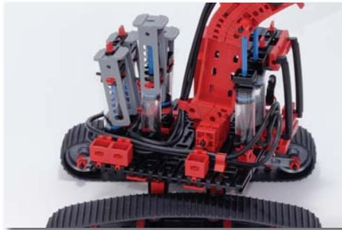
3. Soulevez l'élément de revêtement complet en forme de U de la pelle mécanique.
