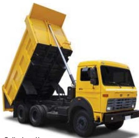
Cylindre télescopique sur une benne de chantier
