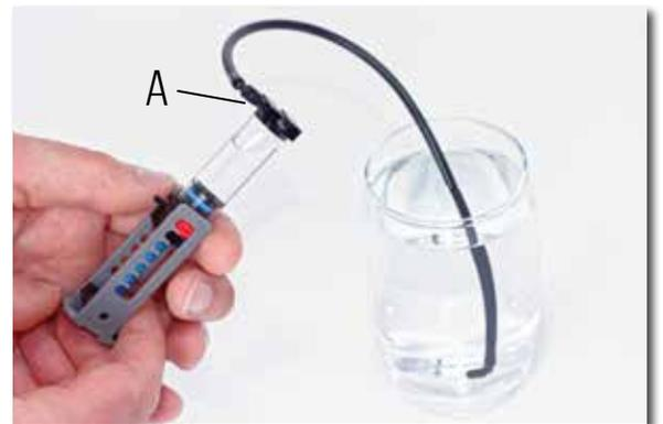
6. Antes de retirar del agua el extremo abierto de la manguera y conectarlo en tu cilindro de trabajo, debes replegar el cilindro de trabajo por completo.
