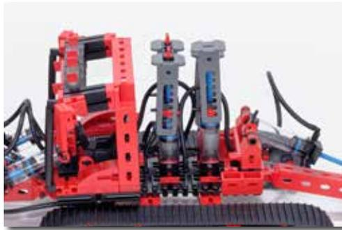
5. Desmonta los cilindros de mando de manera sucesiva.
