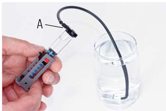
6. Antes de retirar a extremidade aberta da mangueira da água e ligá-la ao seu cilindro, deve retrair completamente o cilindro.
