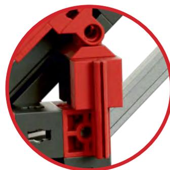
Com a alavanca de travamento (à direita do eixo da serra de arco), é possível fixar o arco da serra na posição superior.
