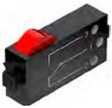
Le bouton est une pièce également appelée « détecteur de contact ». L'actionnement du bouton rouge a pour effet de produire une commutation mécanique : le courant circule entre les contacts 1 (contact moyen) et 3, tandis que le contact entre les raccords 1 et 2 est interrompu. Vous pouvez vous servir du bouton de deux façons différentes :
