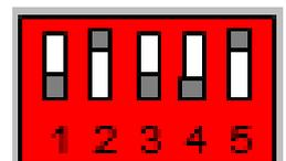
Si votre véhicule robot programmable doit suivre un trajet continuellement, vous pouvez le programmer comme suit. Placez d'abord les interrupteurs DIP 2 et 5 sur ON et tous les autres sur OFF avant la mise en circuit de l'alimentation en courant du module ROBOTICS sur le support de pile. Le
