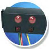
Le dépisteur aux infrarouges est un capteur numérique pour la détection d'une piste noire sur un fond blanc à une distance de 5 à 30 mm. Il est composé de deux éléments d'émission et de réception. Pour effectuer le raccordement, il vous faut une entrée numérique sur le module ROBOTICS et une alimentation en courant de 9 volts (pôle positif et négatif) sur le support de pile.
