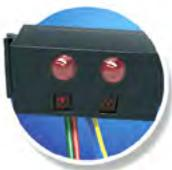
O sensor de rastreamento infravermelho é um sensor digital para a identificação de uma pista preta sobre um fundo branco a distâncias de 5 a 30 mm. Ele consiste de dois elementos de emissão e dois de recepção. Para a conexão, você precisa de uma entrada digital no módulo ROBOTICS e da fonte de alimentação de 9 volts (polos positivo e negativo) no suporte de bateria.
