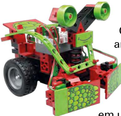
O Mini Bot identificador de obstáculos está equipado em ambos os para-choques com dois botões de pressão que funcionam como sensores. Depois de iniciar o programa, o Mini Bot anda para frente em linha reta. Ele faz isso até que seus para-choques se choquem com um obstáculo.
