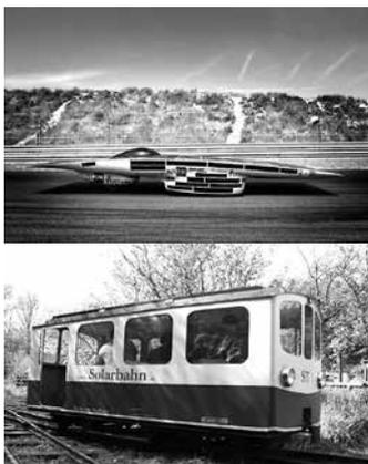
■ Les véhicules solaires obtiennent la majeure partie de leur énergie motrice directement du soleil. Ils disposent d'une surface dotée de cellules solaires, qui transforment l'énergie solaire incidente sur le véhicule en courant électrique. Il s'agit aussi fréquemment de véhicules électriques, qui transportent un réservoir d'énergie (des accumulateurs dans la plupart des cas) avec eux, afin de ne pas devenir inaptes à se déplacer dans des conditions de mauvaise luminosité ou d'un ciel nuageux.
