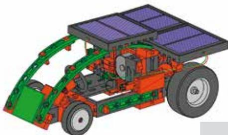
■ La différence entre le montage parallèle et le montage en série des modules solaires réside dans le fait que la tension demeure identique lors d'un montage parallèle, mais qu'elle fournit plus d'électricité qu'un seul module. Le courant demeure identique lors d'un montage en série, bien que la tension des trois modules solaires soit cumulée. Servez-vous du montage en série pour vos essais.
