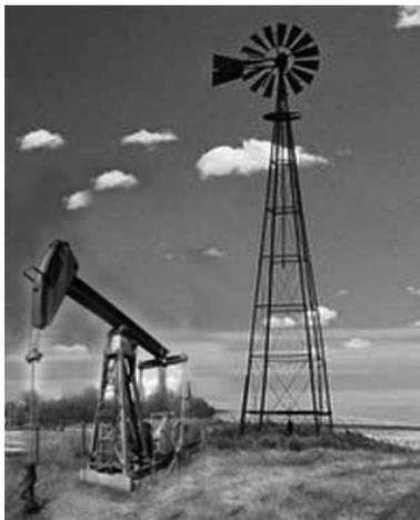
■ Similarmente ao moinho de vento, no modelo turbina eólica com bomba, a energia eólica é transformada em energia de movimento (cinética).
