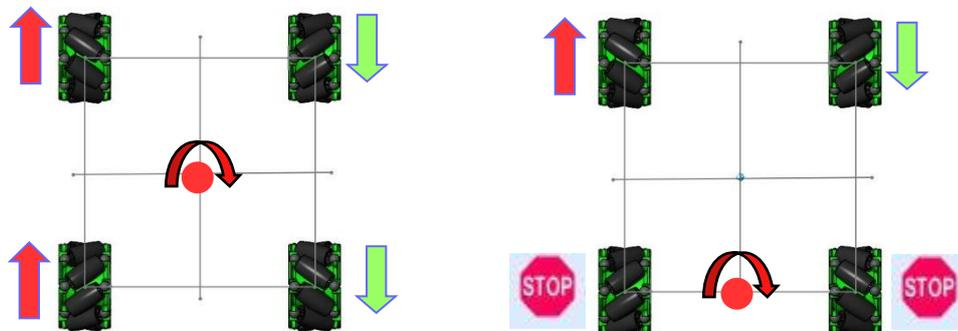
Benötigst du noch weitere Bewegungsrichtungen, musst du nur die Drehrichtung der Motoren ändern, z.B. Drehung nach Links
