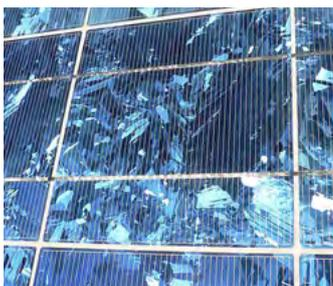
Una celda solar o celda fotovoltaica es un componente eléctrico que convierte la energía radiante contenida en la luz (por regla general luz solar) directamente en energía eléctrica. El fundamento físico de la conversión es el efecto fotovoltaico. La celda solar no debe confundirse con el colector solar, en el cual la energía solar calienta un medio de transmisión (en general agua caliente).
