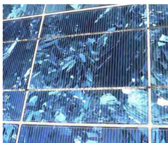
Une cellule solaire ou cellule photovoltaïque est un élément de construction électrique, qui transforme l'énergie rayonnante contenue dans la lumière (la lumière du soleil en règle générale) directement en énergie électrique. La transformation est basée sur le principe physique de l'effet photovoltaïque. Attention : il ne faut pas confondre la cellule solaire avec le collecteur solaire, qui utilise l'énergie solaire pour chauffer un fluide de transfert (l'eau chaude dans la plupart de cas).
