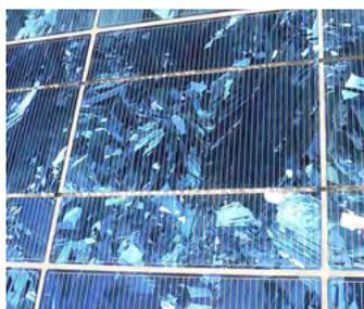
Uma célula solar ou uma célula fotovoltaica é um componente elétrico, que transforma a energia radiante existente na luz (normalmente luz solar) diretamente em energia elétrica. A base física da transformação é o efeito fotovoltaico. A célula solar não deve ser confundida com o coletor solar, no qual a energia solar aquece um meio de transferência (na maioria das vezes, água quente).
