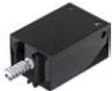
Der XS-Motor ist ein Elektromotor, der genau so lang und so hoch ist wie ein fischertechnik-Baustein. Außerdem ist er sehr leicht. Dadurch kannst du ihn an Stellen einbauen, an denen für die großen Motoren kein Platz ist. Der XS-Motor ist für eine Versorgungsspannung von 9 Volt und einen Stromverbrauch von maximal 0,3 **Ampere** ausgelegt.
