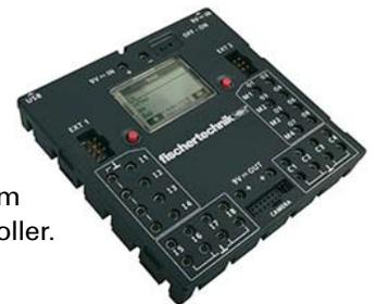
Uma delícia especial é a interface integrada de bluetooth. Através dela poderás ligar o teu PC sem cabo com o ROBO TX Controller. Ou também vários Controllers entre si. Como o Controller trata com os componentes individuais e o que estas devem fazer em detalhe, irás determinar através do programa, que compilas no software ROBO Pro.
