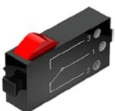
Der Taster wird auch Berührungssensor genannt. Beim Betätigen des roten Knopfes wird mechanisch ein Schalter umgelegt, es fließt Strom zwischen den Kontakten 1 (mittlerer Kontakt) und 3. Gleichzeitig wird der Kontakt zwischen den Anschlüssen 1 und 2 unterbrochen. So kannst du den Taster auf zwei verschiedene Arten verwenden:
