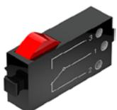
Al pulsador también se le llama sensor de contacto. Al accionar el botón rojo se conmuta mecánicamente el interruptor, fluye corriente entre los contactos 1 (contacto central) y 3. Simultáneamente se interrumpe el contacto entre las conexiones 1 y 2. De este modo puedes emplear el pulsador de dos modos diferentes:
