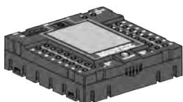
Le ROBOTICS TXT Controller est la pièce maîtresse de cette boîte de construction ROBOTICS. Il commande les [actionneurs](#) et interprète les informations des [capteurs](#).
