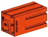
Nous utilisons deux moteurs du codeur contenus dans la boîte de construction pour l'actionnement de nos robots. Il s'agit de moteurs électriques normaux à première vue, soit de moteurs dimensionnés pour une tension de 9 volts et une puissance absorbée maximale de 0,5 ampère.
