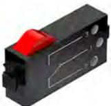
Le bouton est une pièce également appelée « détecteur de contact ». L'actionnement du bouton rouge a pour effet de produire une commutation mécanique : le courant circule entre les contacts 1 (contact moyen) et 3, tandis que le contact entre les raccordements 1 et 2 est interrompu. Vous pouvez vous servir du bouton de deux façons différentes :
