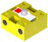
Le phototransistor est une pièce également appelée « détecteur de luminosité ». Il s'agit donc d'un « capteur » réagissant à la luminosité.
