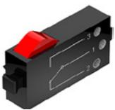
O botão de pressão também é denominado sensor de contato. Ao pressionar o botão vermelho, um interruptor é comutado mecanicamente e corrente flui entre os contatos 1 (contato central) e 3. Simultaneamente, o contato entre as conexões 1 e 2 é interrompido. Assim, você poderá utilizar o botão de pressão de duas maneiras diferentes:
