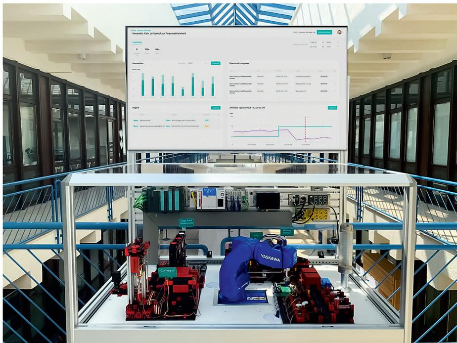
◀ Aktueller und optimierter Prozessraum, basierend auf den Live-Inputs in das Modell. Es wird zu jedem Zeitpunkt (beim Spritzgießen für den nächsten Zyklus) ein optimierter Prozessparametervorschlag erzeugt.
