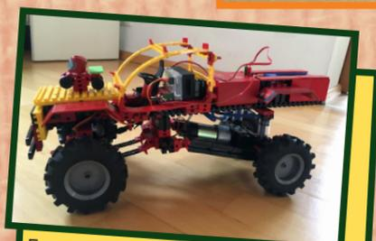
Ferngesteuerter Pickup mit kompressor-gesteuerten Höhenverstellung, Jonas
