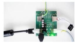
Achten Sie darauf, dass alle Kabel an den Anschluss-Platinen sicher angeschlossen sind. Stecken Sie dann das 24 V-Netzteil und das 9 V-Netzteil in eine Steckdose ein und überprüfen Sie anhand der folgenden Beschreibung mit LED 1 und LED 2, dass die Module korrekt mit Strom versorgt werden.
