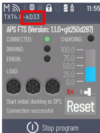
Über die bekannte Oberfläche “Module” können Sie das FTS an das Modul andocken lassen. Per Klick auf den Button „Docke an DPS“ fährt das FTS los und dockt am Modul an.
