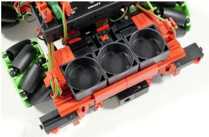
Die Stromversorgung für das FTS wird über den im Lieferumfang enthaltenen fischertechnik Akku bereitgestellt. Diese wird geladen ausgeliefert, sodass Sie das FTS direkt starten können.
