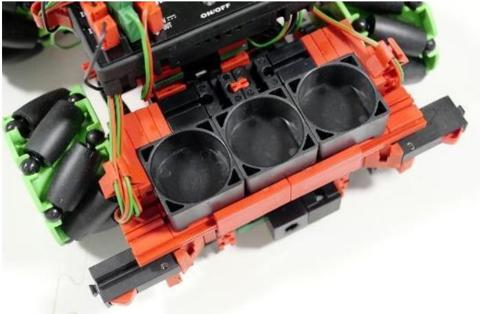
La alimentación energética del AGV se establece a través de la batería fischertechnik incluida en el volumen de suministro, la cual se entrega cargada para poder iniciar el AGV de forma directa.
