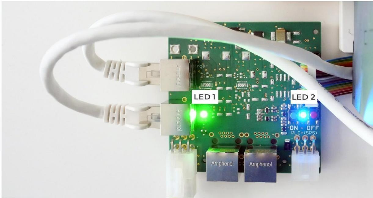
Además, en cada placa de conexión para la alimentación energética hay dos interruptores junto al led 2. Estos sirven como parada de emergencia del módulo correspondiente.
