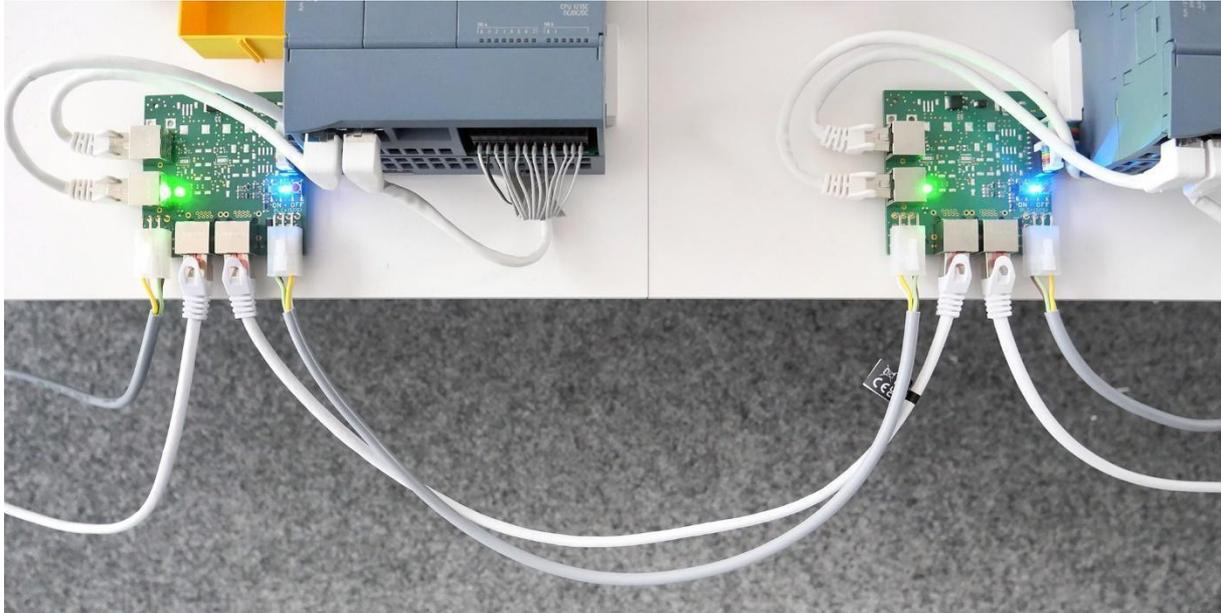
Todos los módulos, el enrutador y el Raspberry Pi se inician automáticamente cuando la alimentación energética está activa, los programas necesarios están previamente instalados.
