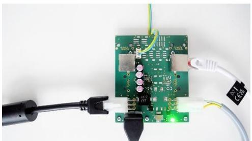
Asegúrese de que todos los cables estén conectados de forma segura a las placas de conexión. A continuación, conecte la fuente de alimentación de 24 V y la fuente de alimentación de 9 V en el enchufe y compruebe a través del led 1 y el led 2, según se indica a continuación, que los módulos reciban la correcta alimentación eléctrica.
