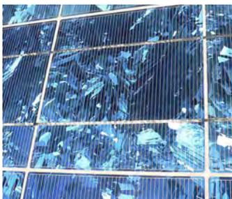
Eine Solarzelle oder photovoltaische Zelle ist ein elektrisches Bauelement, das die im Licht (in der Regel Sonnenlicht) enthaltene Strahlungsenergie direkt in elektrische Energie wandelt. Die physikalische Grundlage der Umwandlung ist der photovoltaische Effekt. Die Solarzelle darf nicht mit dem Sonnenkollektor verwechselt werden, bei dem die Sonnenenergie ein Übertragungsmedium (meist Heizwasser) aufheizt.
