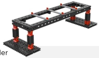
Bitte beachte, dass wir für diese Werte das halbe Gewicht der Brücke vom Messwert abgezogen werden muss. In der Realität ist die Gewichtskraft einer Brücke sehr viel größer im Verhältnis zu den Verkehrs- oder Windlasten, welche auf das Bauwerk wirken.
