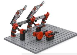
2. Justiere den Exzenter so, dass der Ansatzpunkt der I-Strebe 45 extrem weit vom Drehpunkt der Antriebsachse entfernt ist („vergrößere die Exzentrizität“). Was passiert beim Kurbeln?
