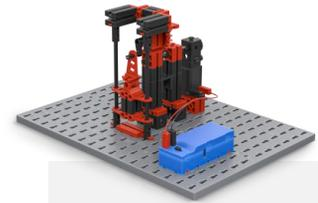
Durch die Exzenter-Kurbel und das Gelenk im Pressenkopf wird die Drehbewegung in eine **lineare Auf- und Ab-Bewegung** umgesetzt. In die Presse könnten unterschiedlich hohe zu pressende Werkstücke eingelegt werden.
