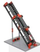
Bei 30° Aufstellwinkel benötigen wir eine Aufstellhilfe mit genau der halben Länge der 18 Rasteinheiten. Das sind also
