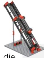
Mit zunehmendem Winkel wird  $\sin(\alpha)$  größer, wodurch auch die Hangabtriebskraft steigt. Diese zusätzliche Kraft führt zu einer stärkeren Beschleunigung des Wagens, da die Reibungskraft (wenn sie überwunden wurde) im Vergleich zur Hangabtriebskraft weniger ins Gewicht fällt.
