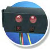
Der Infrarot-Spursensor ist ein digitaler Sensor zur Erkennung einer schwarzen Spur auf weißem Untergrund mit einem Abstand von 5 – 30 mm. Er besteht aus zwei Sende- und Empfängerelementen. Als Anschluss benötigst du einen digitalen Eingang am ROBOTICS-Modul und die 9 Volt Spannungsversorgung (Plus- und Minus-Pol) am Batteriehalter.
