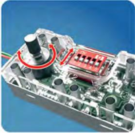
Über den Potentiometer am ROBOTICS-Modul, auch Poti genannt, kannst du die Geschwindigkeit der beiden Antriebsmotoren steuern. In der Mittelstellung des Poti (Ansicht von oben, dass DIP-Schalterbezeichnung lesbar ist) drehen sich beide Antriebsmotoren gleich schnell und somit fährt der Mini Bot vorwärts geradeaus. Drehst du den Poti nach links, fährt er eine Vorwärtslinkskurve. Drehst du den Poti nach rechts, fährt er eine Vorwärtsrechtskurve.
