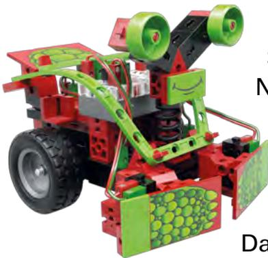
Der Mini Bot Hinderniserkenner ist an den beiden Stoßstangen mit zwei Tastern als Sensoren ausgestattet. Nach Start des Programmes fährt der Mini Bot geradeaus. Dies macht er so lange, bis er mit einer seiner Stoßstangen gegen ein Hindernis stößt.
